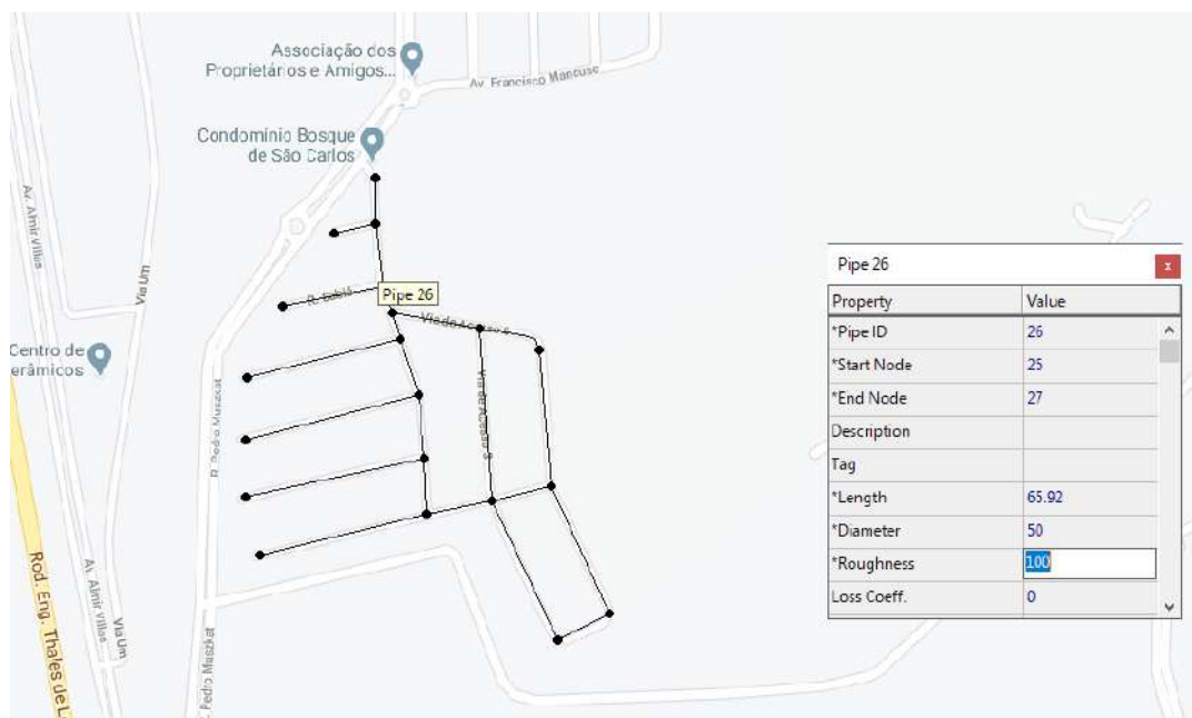
Figura 111: Traçando uma rede de distribuição de água sobre um mapa escalado.
