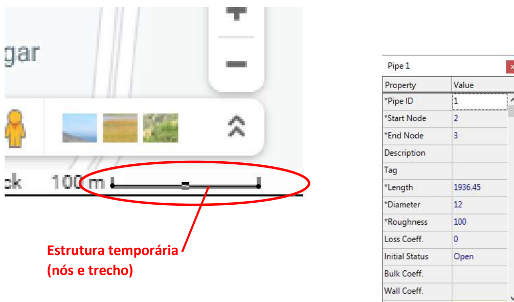
Figura 106: Características do trecho de tubulação implantado temporariamente.
