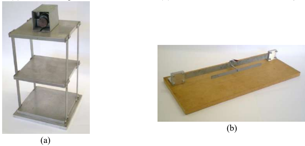
Figura 4 – (a) Sistema de plataformas oscilantes; (b) Absorvedor dinâmico de vibrações
